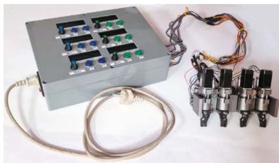
Рисунок 4 — Внешний вид полуавтоматической системы юстировки. Слева — электронный блок. Справа — механический блок
