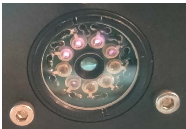
Рисунок 3 — Внешний вид макета оптической системы оптоэлектронного прибора
