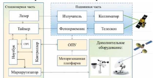
Рисунок 4 — Обобщённая структурная схема АК КОС
