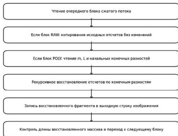
Рисунок 2 — Блок-схема процедуры декомпрессии сигнала
