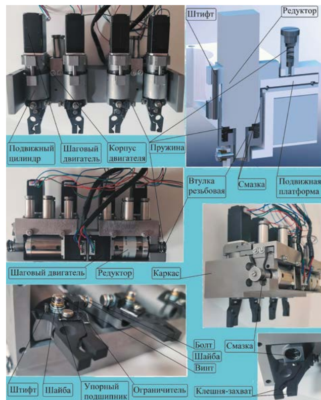
Рисунок 5 — Механический блок автоматической системы юстировки
