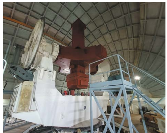
Рисунок 1 — ОПУ с ГВМ в подкупольном пространстве ТИ
