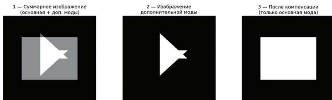
Рисунок 3 – Иллюстрация принципа компенсации сигнала изображения от дополнительных мод
