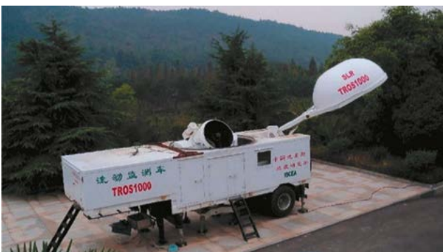
Рисунок 3 - Китайская транспортируемая станция TROS1000
